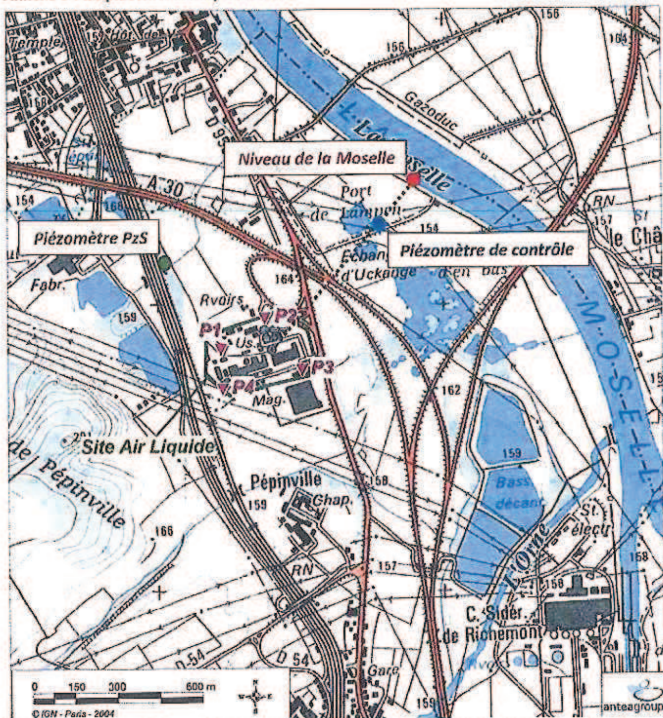
Piezomètre de surveillance (PzS) et piézomètre de contrôle (PzC) liés à l'exploitation des forages (P1 à P4)
